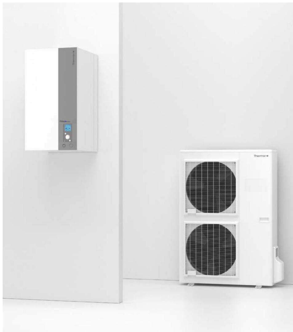
Não importa o frio que está: até com -20 °C no exterior, a Alféa Excellia Ai mantém a temperatura de impulsão do aquecimento a 60 °C graças ao seu sistema de reinjeção de líquido, o que a torna numa clara alternativa para renovar a caldeira de uma instalação já existente.
