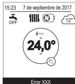
Si el error viene de la unidad exterior, la interfaz del usuario muestra el código de error "370: Generador termodinámico" seguido del error de la unidad exterior.
