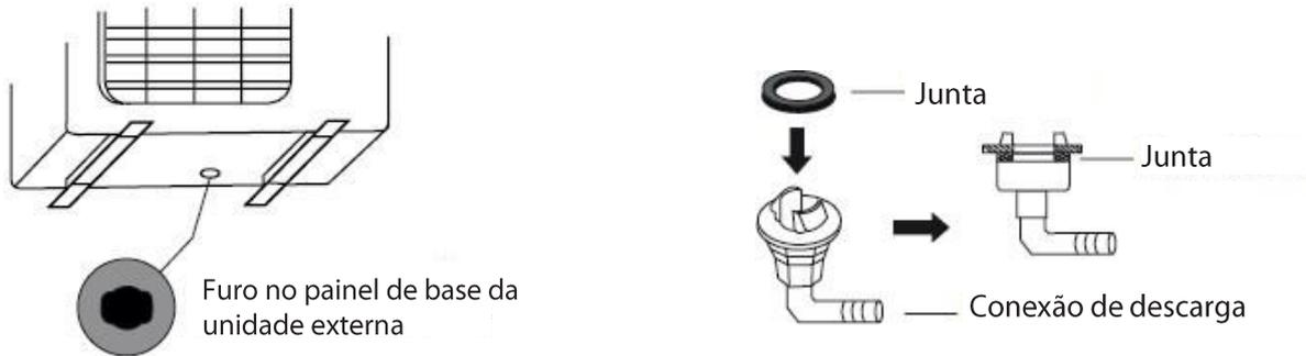
Cada unidade é fornecida, com base no kit hidráulico (na altura do lado da bateria), com um furo para a descarga dessa possível condensação que pode passar pelas tubulações do sistema hidráulico. Com estes tubos bem isolados, a produção de condensação é mínima.
