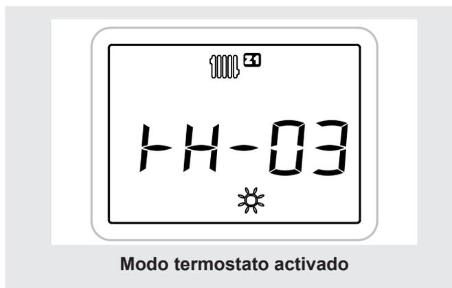
En modo termostato, la consigna de salida se calcula en función de la temperatura exterior (0 °C si la instalación no está equipada de sonda exterior).
