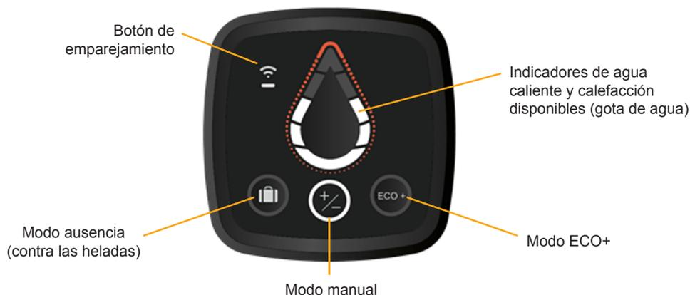
**NOTA:** Si el aparato está inactivo durante 60 segundos, la interfaz pasa al modo de espera y se apaga la gota de agua. Cada 10 segundos parpadean: el círculo del modo seleccionado y la conexión Wi-Fi si el equipo está conectado. Es posible apagar la interfaz pulsando simultáneamente las teclas ECO+ y «Ausencia» durante 3 segundos. El visualizador se vuelve a activar transitoriamente al tocar cualquier tecla; al cabo de un tiempo, se desconecta de nuevo. El aparato sigue en funcionamiento.
