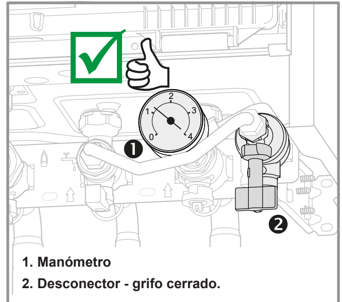
figura 3 - Control de la presión hidráulica
